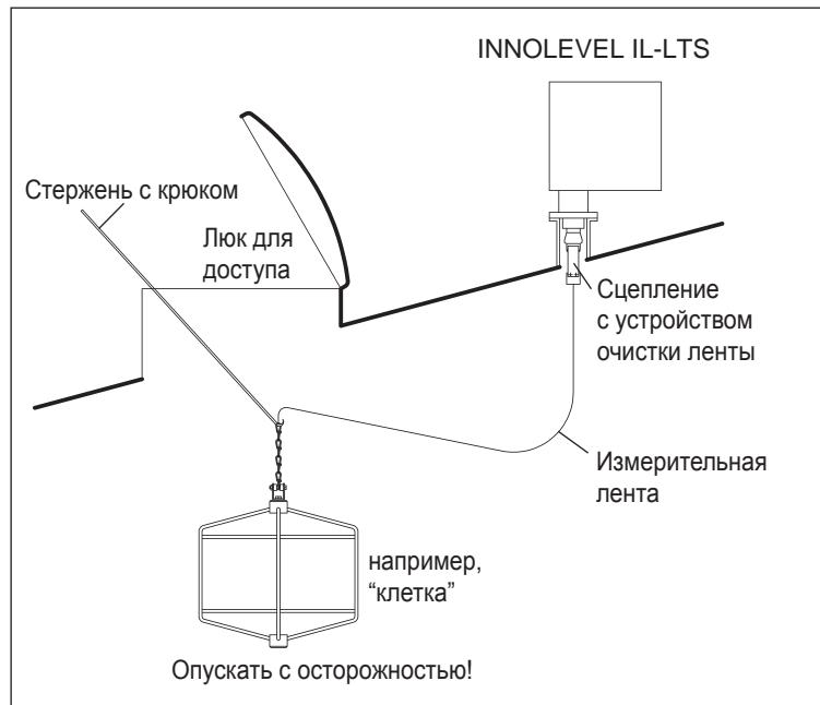
Измерительная лента зажимается в креплении для ленты двумя винтами. Третий винт фиксирует цепь. Вертуш (вращающееся шарнирное соединение) монтируется на нижнем элементе цепи, чтобы принимать на себя любое вращательное движение измерительного груза.
