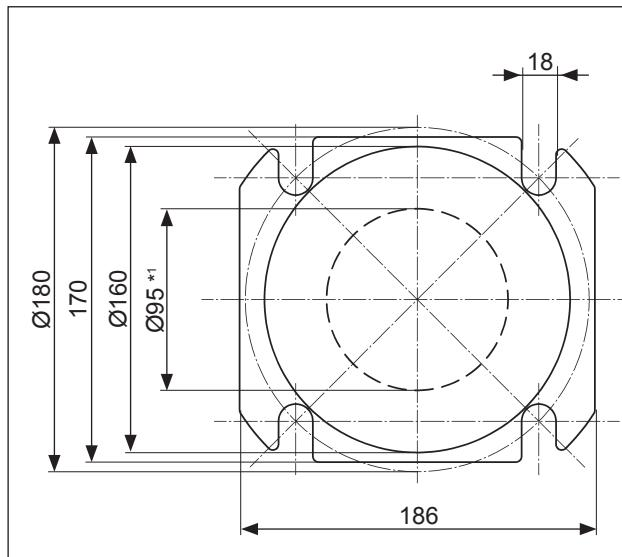
\*1 Минимальный размер для установки механизма очистки ленты и стандартного груза
